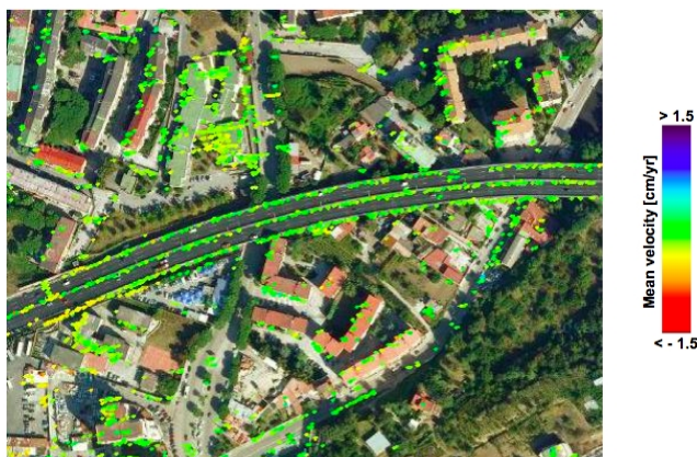
Figura 5 – Mappa di velocità di deformazione ricavata dai dati Cosmo-SkyMed, sovrapposta a un'immagine ottica della zona, relativa a un tratto autostradale in prossimità della città di Napoli. I punti coerenti seguono perfettamente i contorni delle strutture presenti e del tracciato autostradale.
