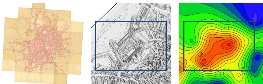
Figura 12 – Attraverso il parametro di dilatazione D è possibile dimostrare analiticamente che il castello sforzesco è stato disegnato da Lafrèry diminuendo la scala di rappresentazione, presumibilmente per motivi di celebrazione del potere politico.
