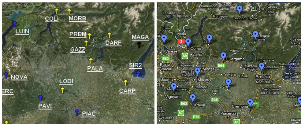
Figura 1 – Disposizione delle SP delle reti ItalPOS (sx) e GPSLombardia (dx).
