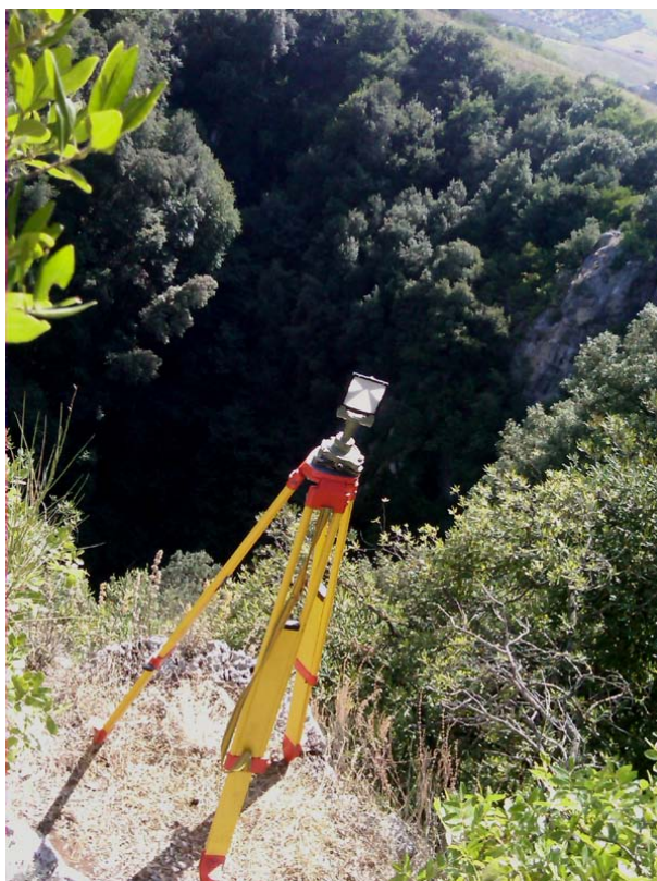
Figura 1 – Panoramica del sito in corrispondenza di uno dei punti usati per appoggiare il rilievo laser.
