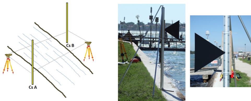
Figura 2 – Da sinistra a destra schema semplificato di attraversamento mediante livelli in posizione reciproca ed esempio di mira collegata alla stadia per le letture da grandi distanze.
