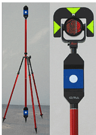
Figura 10 – Target Leica HDS Twin Target Pole utilizzato per il collegamento tra stazioni del C10.
