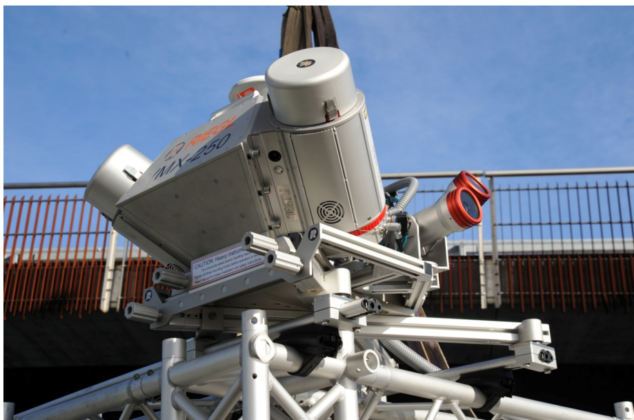
Figura 3 – Lo strumento di acquisizione composto da scanner rotativi e camere digitali.
