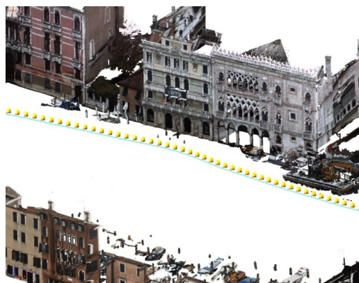
Figura 6 – Vista della nuvola di punti 3d colorati con indicazione della traiettoria percorsa dal natante (colore ciano) e delle posizioni delle camere digitali in una singola passata (giallo e rosso).
