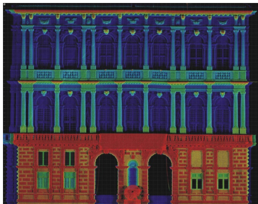
Figura 11 – Vista ortogonale della facciata in falsi colori in funzione della profondità da un piano di riferimento.
