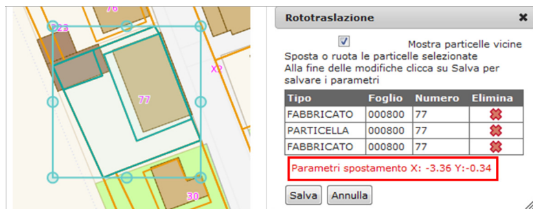
Figura 3 – Esempio di armonizzazione delle mappe catastali al DbT.
