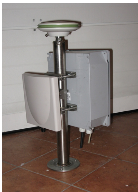
Figura 5 – Unità Rover, con l'antenna GNSS e l'antenna wlan.
