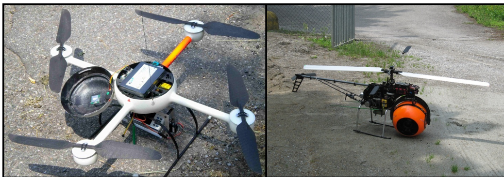
Figura 4 – Microdrones MD4-200 ed elicottero per le riprese indoor.
