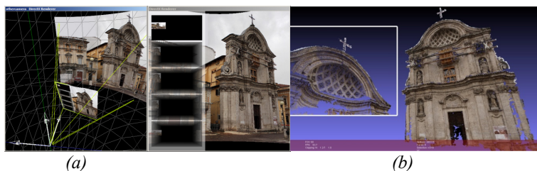
Figura 4 – Formazione di immagini ad alta risoluzione per restituzione automatizzata di punti (a), Nuvole di punti tramite procedure di Structure for Motion (b).
