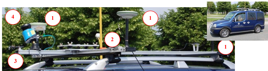
Figura 1 – Sistema mobile mapping utilizzato e sensori installati.
