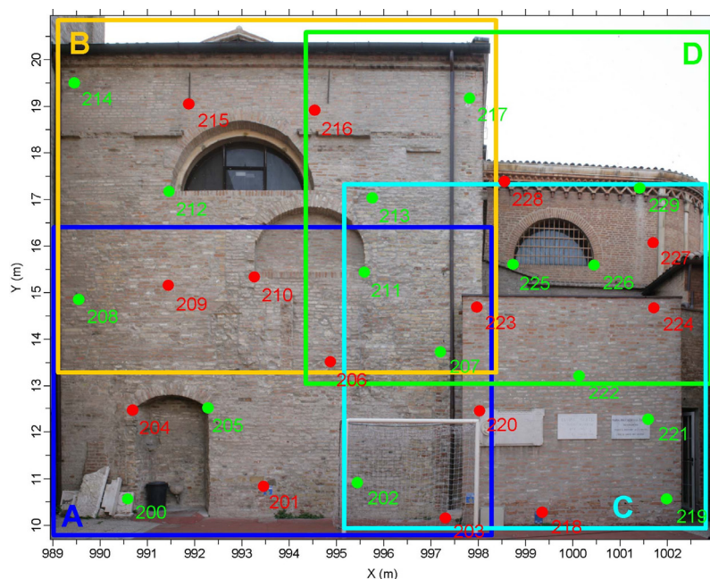
Figura 8 – Localizzazione dei PFA (in verde) e dei CP (in rosso) nell'orientamento di ogni singolo modello con almeno 6 PFA.
