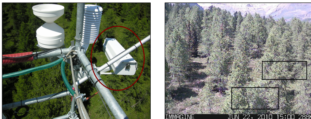
Figura 1 – a) Webcam modello CC640 installata presso il sito sperimentale di Torgnon (AO). b) Area ripresa dalla webcam. In nero la regione di interesse impiegata nell'analisi.
