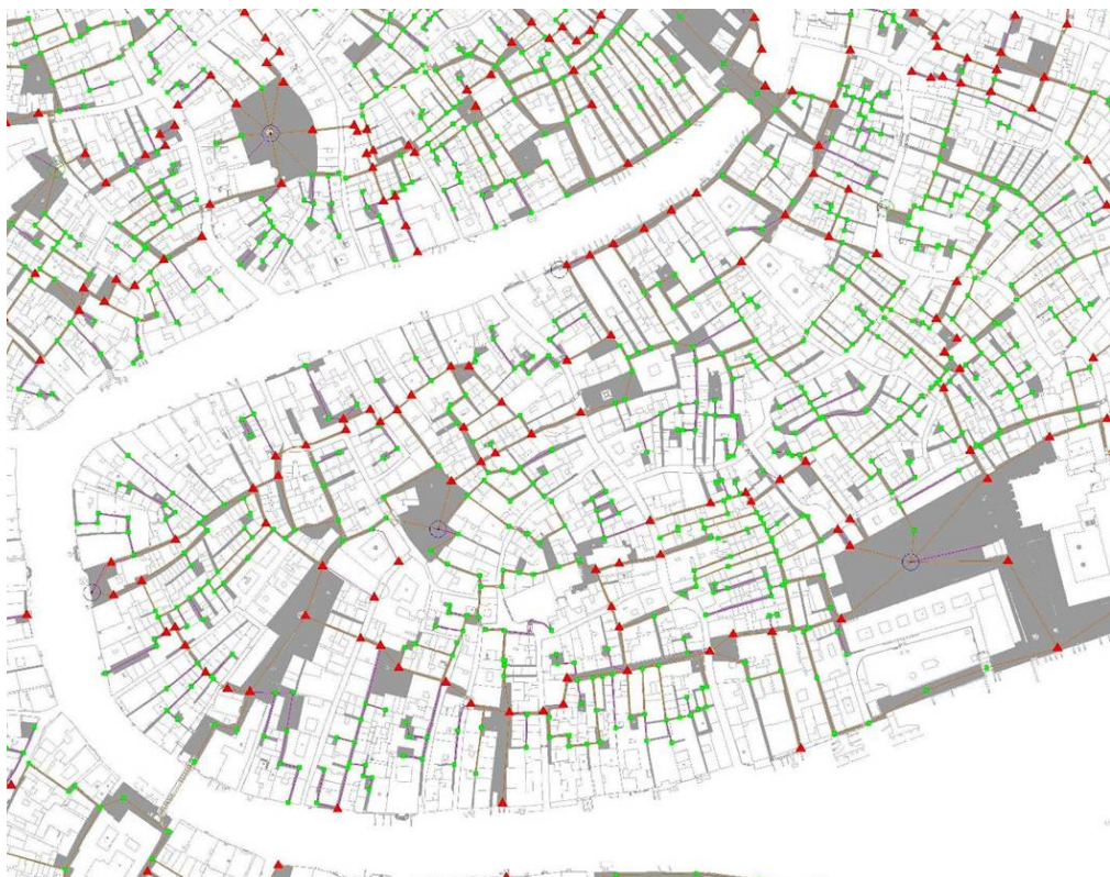
Figura 8 – Rete di raffittimento.
