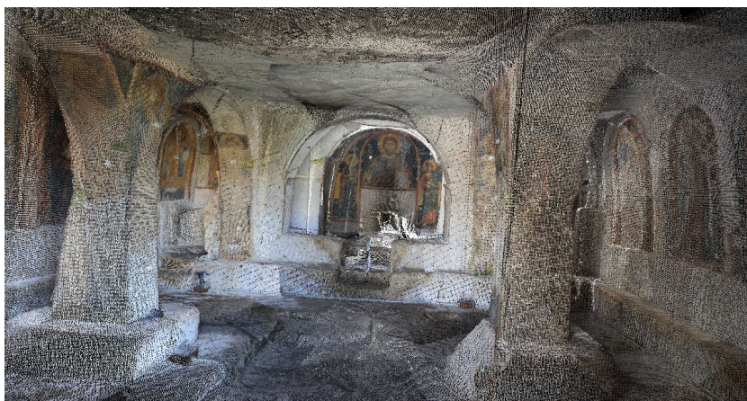
Figura 5 – Modello a nuvola di punti associato al colore RGB.
