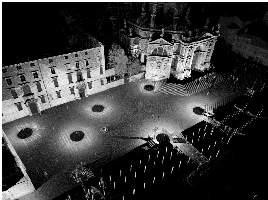
Figura 9 – Nuvole di punti di campo della Salute.
