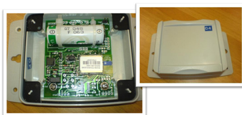
Figura 11 – TAG ZigBee per rimorchio.
