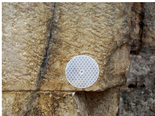
Figura 4 – Target adesivi utilizzati per la giunzione delle nuvole di punti.
