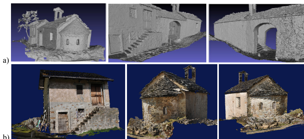
Figura 12 – Modellazione 3D con laser scanner e texturing automatico. Dato geometrico (a) e modello finale texturizzato usando circa 60 immagini (b).
