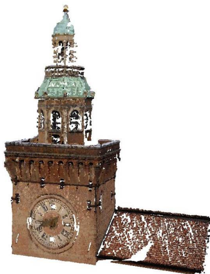
Figura 6 – Nuvole di punti estratte per la torre di palazzo D'Accursio.
