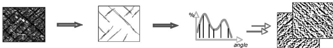
Figura 1 –Filtratura direzionale adattativa applicata ad una porzione di immagine radar ad alta risoluzione di area urbana.
