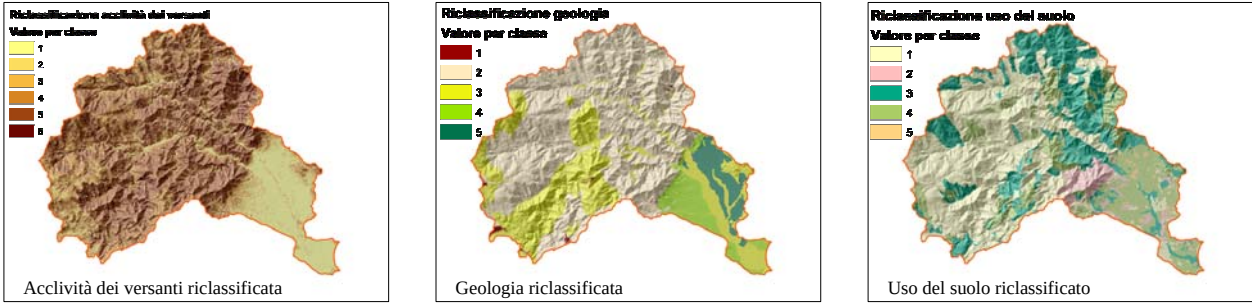
Figura 3. Livelli informativi riclassificati utilizzati per l’applicazione del modello matematico per l’instabilità potenziale dei versanti elaborato sulla base delle linee guida del PAI.
