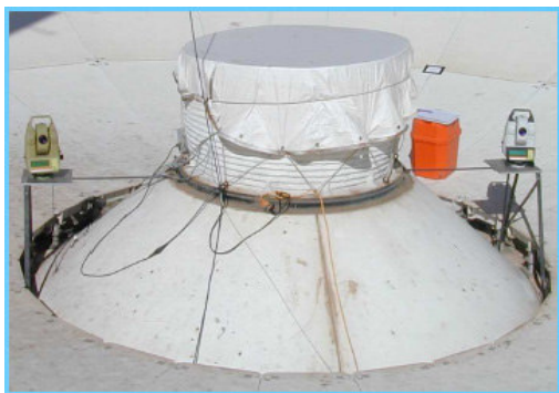
Figura 4 - Strumenti TC2003 e TDA5005 nei punti di stazioneamento F2 ed F1 all'interno del VLBI
