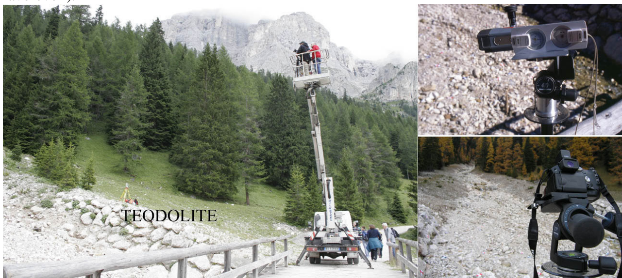
Figura 2: La strumentazione di campo utilizzata: a sinistra la piattaforma aerea su autocarro e il teodolite; a destra in basso la foto-camera digitale; a destra in alto il distanziometro e il clisimetro.
