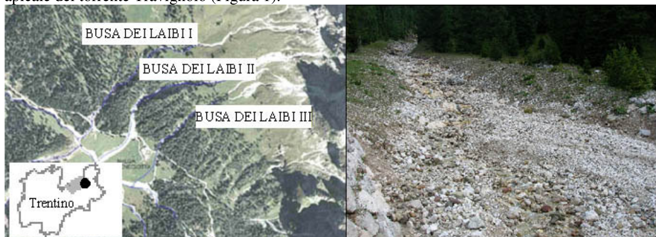
Figura 1 - A sinistra: localizzazione del torrente Busa dei Laibi II in provincia di Trento; a destra: immagine, dal ponte sulla strada forestale denominata Venegia – Pian della Mezzana verso monte, del tratto sistemato con catene di massi ciclopici legati. In primo piano la zona di espansione subito a monte del ponte.
