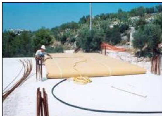
Figura 4: collaudo statico di un solaio con serbatoio flessibile per simulazione carico ripartito
