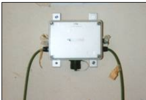
Figura 6: sensore inclinometrico biassiale e centralina per acquisizione dati
