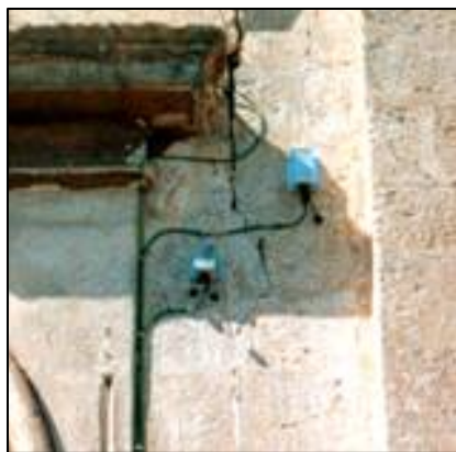
Figura 6: sensore inclinometrico biassiale e centralina per acquisizione dati
