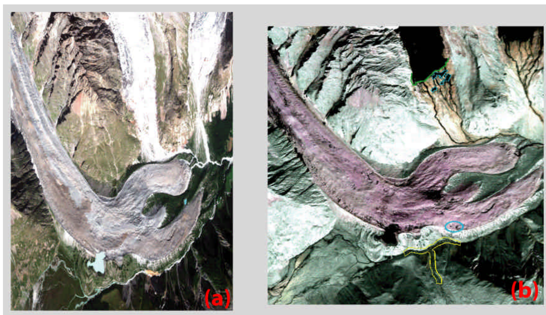
Figura 5 – Immagini MIVIS della zona del ghiacciaio del Miage (Courmayeur): (a) immagine grazza (sintesi a colori reali); (b) ortoproiezione mediante metodo parametrico PARGE (sintesi nell'infrarosso termico). A partire dall'ortofoto ottenuta è stato possibile, per esempio, analizzare radiometricamente l'immagine, sfruttando le ottime caratteristiche dello spettrometro del termico; ne è risultata una buona caratterizzazione geomorfologica dell'ambiente glaciale del Miage, contraddistinto dalla presenza di una lingua glaciale interamente coperta da detriti (glacier noir) ricollegabili a diversi eventi gravitativi.
