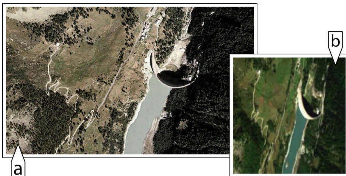
Figura 1- Esempio di immagine MIVIS sulla stessa zona di territorio - (a) ortofoto alla scala 1:10000 (b) immagine MIVIS “grezza”. Risulta evidente come l’immagine MIVIS non riproduca correttamente la reale geometria della superficie inquadrata e necessiti quindi di correzioni geometriche prima di un suo utilizzo cartografico.
