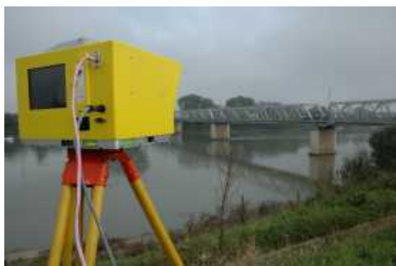
figura 1 – fiume Po. A sinistra, rilievo con laser scanner. A destra, batimetria (in alto) e immagine Side Scan (sotto) dell'area del ponte in cui si individuano macerie attorno alle fondamenta.
