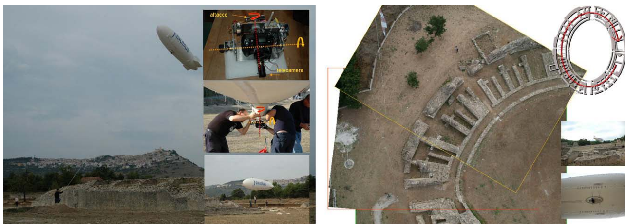
fig. 2 la fotogrammetria da pallone: a sinistra, il sistema di ancoraggio della camera; a destra, dettaglio di una strisciata sull'anfiteatro
