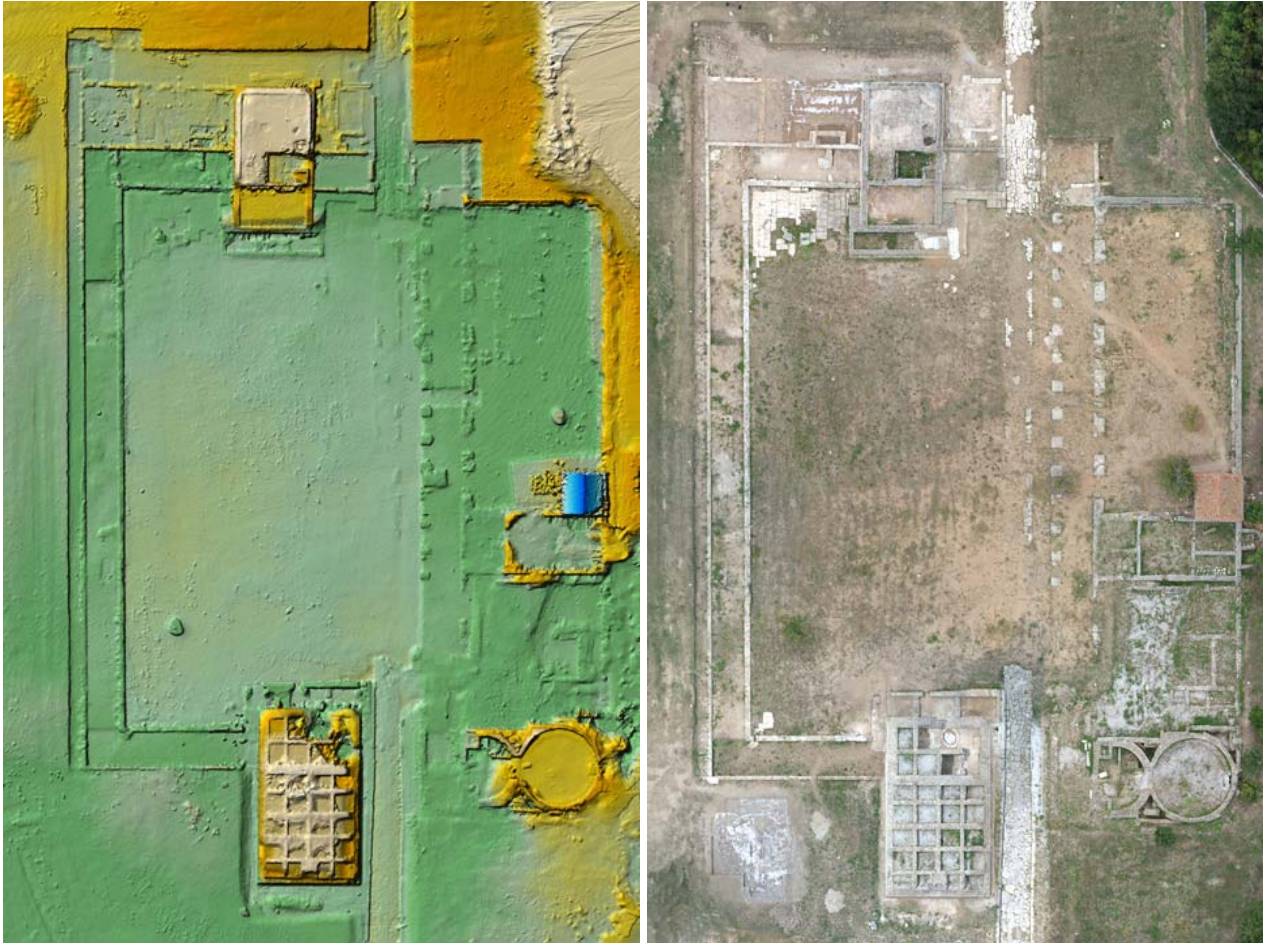
fig.3 A sinistra il modello digitale dell'area del foro. A destra, l'ortofoto del foro realizzata con i fotogrammi acquisiti sia da pallone che da aereo per una scala nominale 1:200
