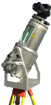
Figura 2- Sensore terrestre RIEGL LMS Z420
