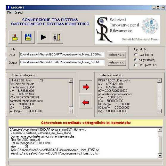
Figura 7: Software Isocart per la conversione tra il sistema di riferimento cartografico e l'isometrico
