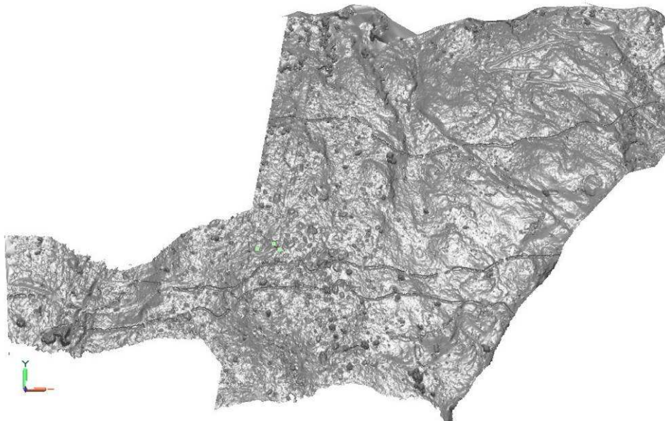
Figura 6- DDSM ottenuto dalla scansione laser da elicottero
