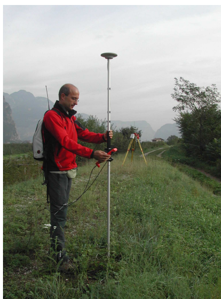
Fig. 4 rilievo confine in RT
