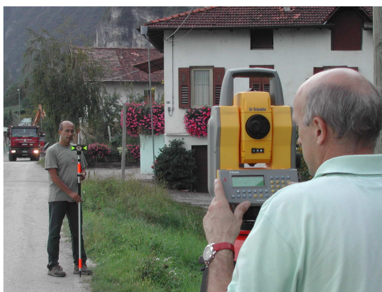
Fig. 5 rilievo confine con teodolite
