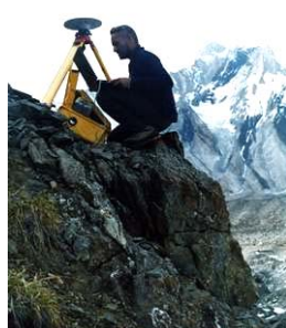
Figure 2 e 3 – A sinistra caposaldo di riferimento presso Concordia (Archivio Desio). A destra, caposaldo GPS sulle pendici del Mitre Peak (foto Belò)
