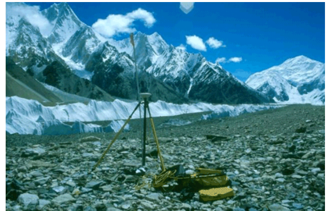
Figure 4 e 5 – Distribuzione delle paline sulla superficie del Ghiacciaio Baltoro (sinistra). A destra il Rover Trimble 5700 in acquisizione presso la palina BS01 (foto Belò)
