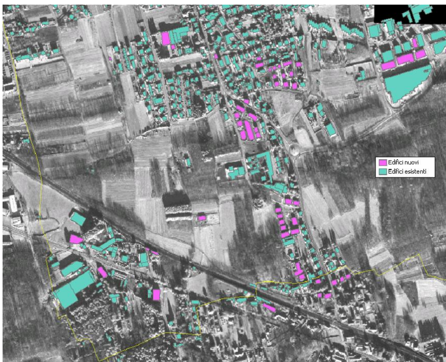
Figura 3 - Risultato dell'aggiornamento della copertura aerofotogrammetrica esistente tramite digitalizzazione dei nuovi edifici
