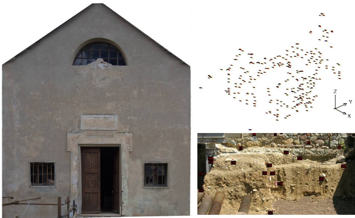
Figura 3 – Fotopiano della facciata principale; Modello tridimensionale dei punti battuti; Monografia fotografica dei punti topografici di controllo
