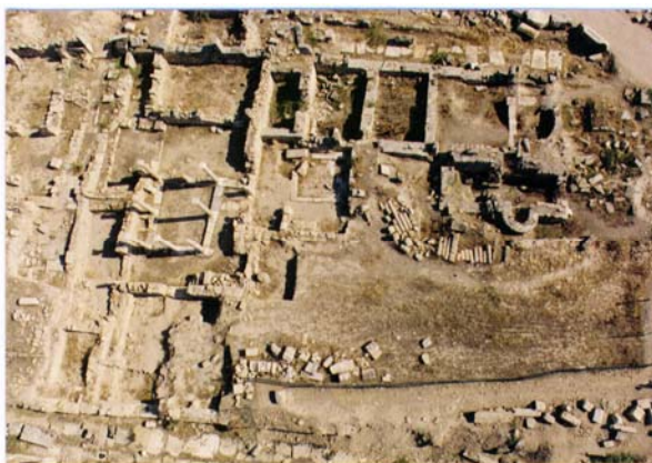
Figura 1-2 – Differenze tra casi di studio: ampio cantiere di scavo di edilizia residenziale antica, rilevato con tecniche integrate topografico-fotogrammetriche, e oggetto di studio monumentale e monofunzionale rilevato con tecniche laser scanner e fotogrammetriche.
