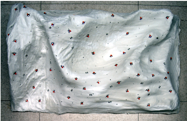
Figura 3 – Modello in gesso per controllo DEM ottenuto.
