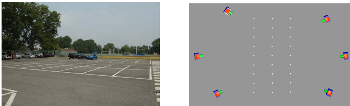
Figura 2 – Una delle immagini del Parcheggio utilizzata nel test e schema delle prese e dei GCP
