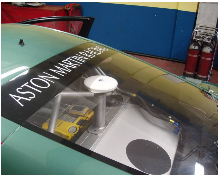
Figura 1 – Sensori GPS all'interno del veicolo
