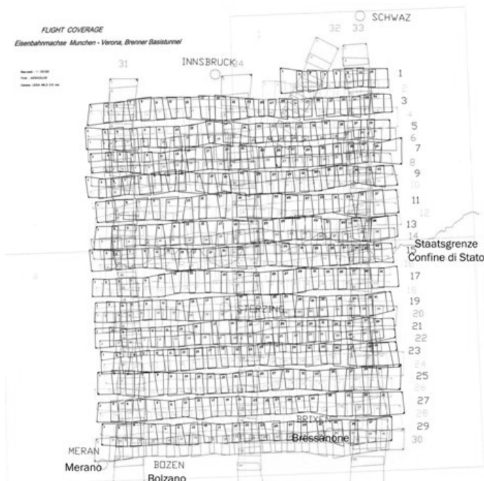
Figura 6 – Il volo fotogrammetrico
