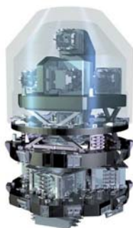
Figura 1 - Lo strumento principale a bordo di GOCE è un gradiometro triassiale; qui è presentata una vista dello strumento assemblato (immagine ESA)
