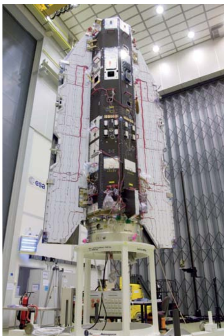
Figura 2 - GOCE nella "clean room" presso la sede ESA ESTEC di Noordwijk (Olanda) durante una delle numerose fasi di testing prima del lancio (foto ESA)
