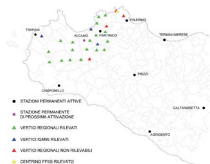
Figura 1 – Ubicazione delle stazioni permanenti e dei vertici scelti per la sperimentazione
