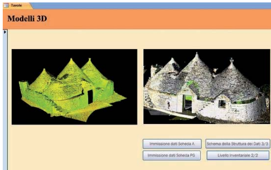
Figura 8 – Scheda di modellazione 3D laser scanner
