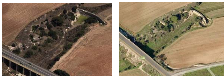
Figura 4 - Immagini aeree della briglia prima e dopo il crollo dell'imposta di sinistra
