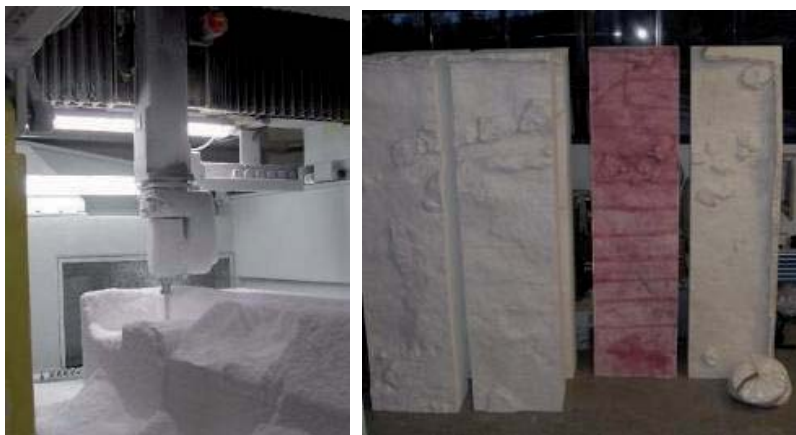
Figura 9 – Fasi di lavorazione della fresa
