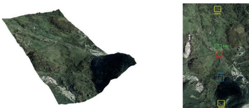
Figura 2 (a) Rappresentazione 3D del DSM estratto sulla zona di Lauria. (b) indicazione delle zone nelle quali sono state applicate le verifiche imposte dalle norme CISIS
