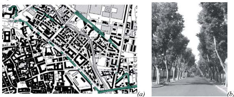
Figura 3 – Traiettorie (a) ed esempio di ostacolo alla ricezione del segnale satellitare (b) del test in ambiente urbano
