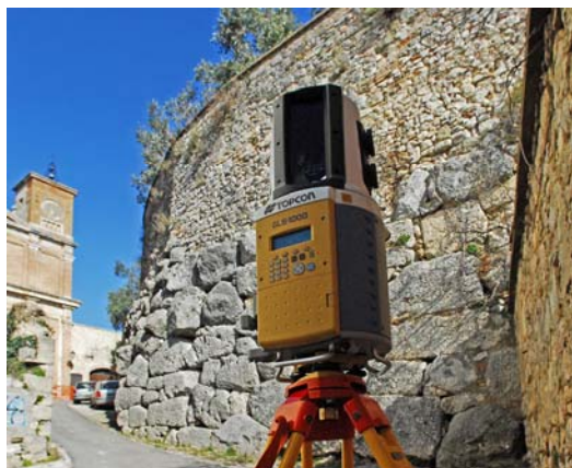
Figura 3 – Rilievo delle mura megalitiche con laser scanner Topcon GLS-1000
