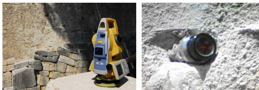
Figura 4a – Rilievo con stazione totale Topcon IS Figura 4b – Immagine durante la misura di un prisma
