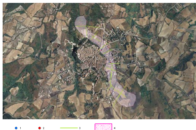
Figura 2 - Ortofoto dell'area in cui ricade l'abitato con rappresentazione delle indagini eseguite. Legenda: 1) Sondaggio meccanico a carotaggio continuo attrezzato a piezometro; 2) Sondaggio meccanico a distruzione di nucleo attrezzato a inclinometro; 3) Traccia di stendimento di tomografia elettrica; 4) Area a pericolosità geomorfologica molto elevata (PG3) individuata dal Piano di Bacino Stralcio di Assetto Idrogeologico (P.A.I.) vigente.
