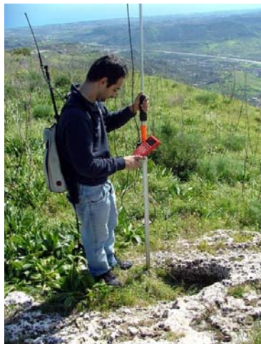
Figura 3 – Rilevamento, Rover GPS Leica 1200 in modalità RTK, dettaglio dell'area cimiteriale
