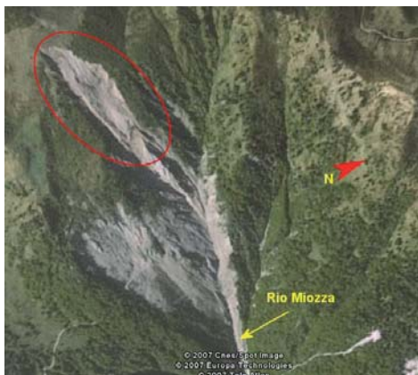
Figura 3: In rosso la parte sommitaria del corpo di frana principale, interessata dal rilievo laser terrestre.
