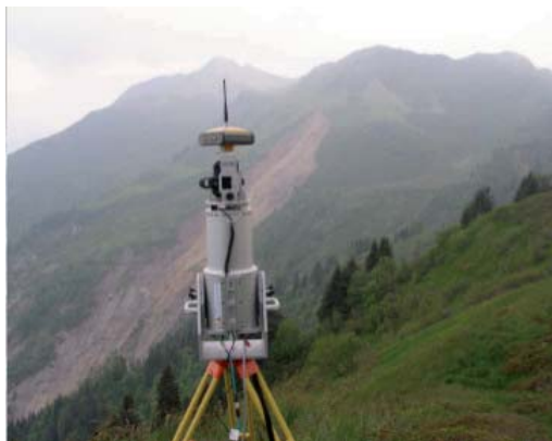
Figura 6: Riegl LMS-Z620 con fotocamera digitale e GPS Topcon in acquisizione. Sullo sfondo è visibile l'area di frana principale.
