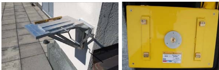
Figura 3: piastra di riposizionamento (sinistra) e predisposizione del sistema di aggancio sul sensore (destra).
