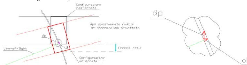
Fig. 3 – Concio di trave soggetto a rototraslazione e scomposizione del vettore spostamento “d”
