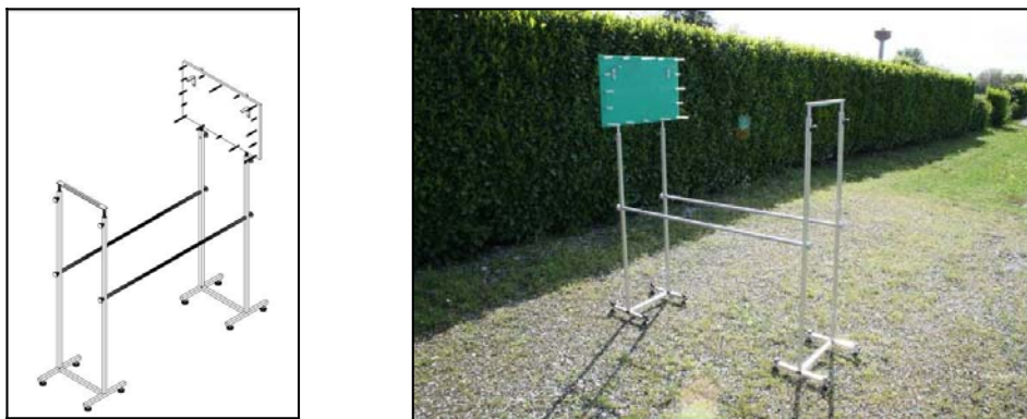
Figura 1 –Progetto e manufatto del sistema destinato al rilievo fotogrammetrico degli alveari.
