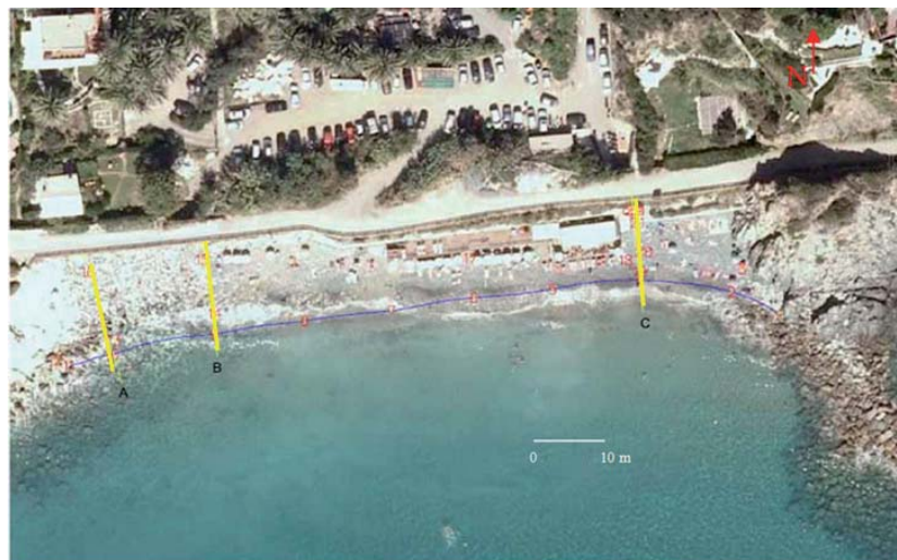
Figura 2 - Localizzazione del rilievo e stazioni GPS in corrispondenza delle sezioni trasversali. A, B e C sono le sezioni di Fig. 3.
