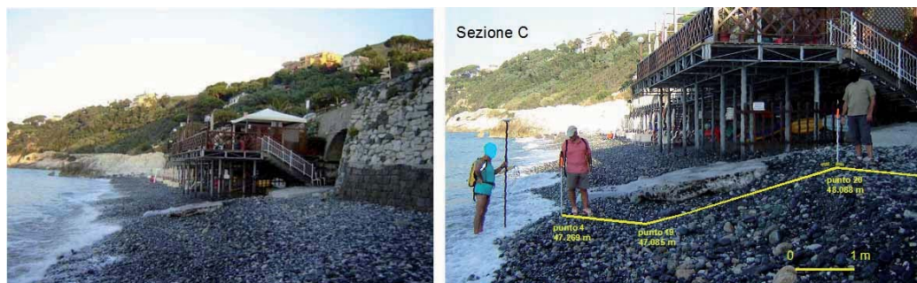
Figura 4 - Area di studio vista da levante (a sinistra); confronto tra le quote ellissoidiche determinate con il GPS e l'immagine fotografica (a destra) su cui è riportato il profilo (sezione C).
