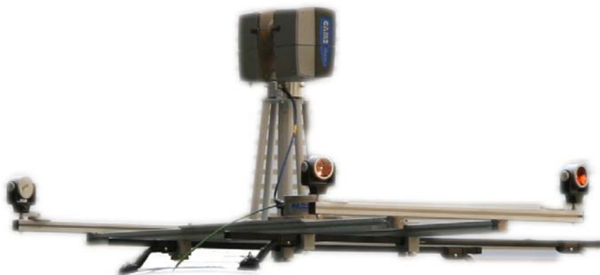
Figura 1 - piattaforma montata sul tetto del mezzo mobile
