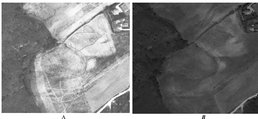
Figura 2 Confronto tra Terraitaly 2005 (A) e l'immagine IKONOS elaborata (B) di un'area in frana nell'area di studio di Collazzone. Le evidenze della frana sono indicate dalla linea blu nell'immagine Terraitaly. La differenza di copertura vegetale delle due immagini è dovuta alla acquisizione non perfettamente contemporanea nell'arco della stessa stagione estiva.
